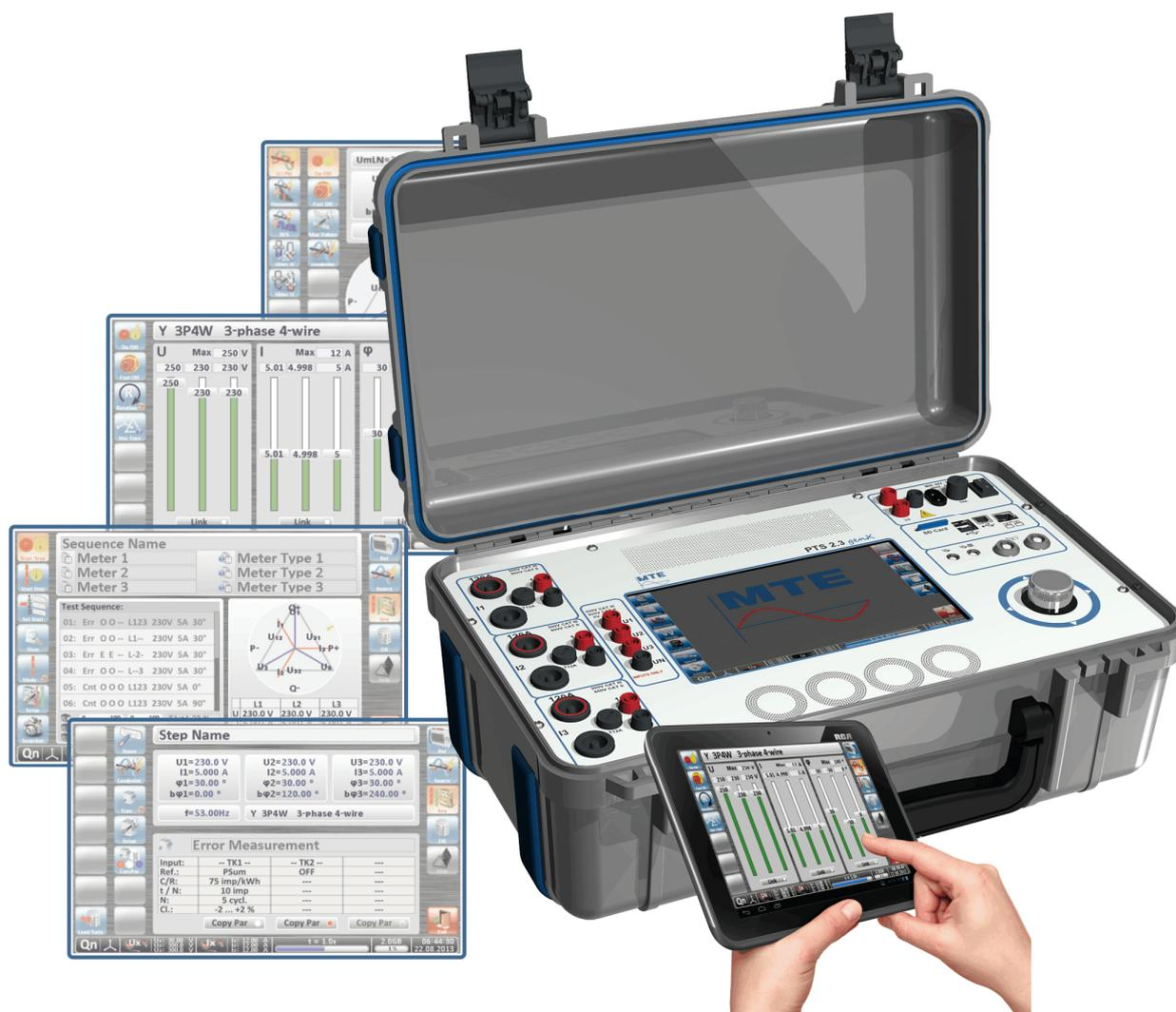
El PTS 2.3 genX está compuesto por una fuente de intensidad trifásica y un patrón trifásico electrónico de clase 0.1. Las características de la PTS 2.3 genX son su amplio rango de medición, alta precisión y alta tolerancia a influencias externas no deseadas.
